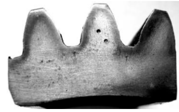
Рисунок 3.2 – Травлений шліф (темп лет) цементованої шестірні (два відпечатки на зубі – сліди випробовування твердості)
